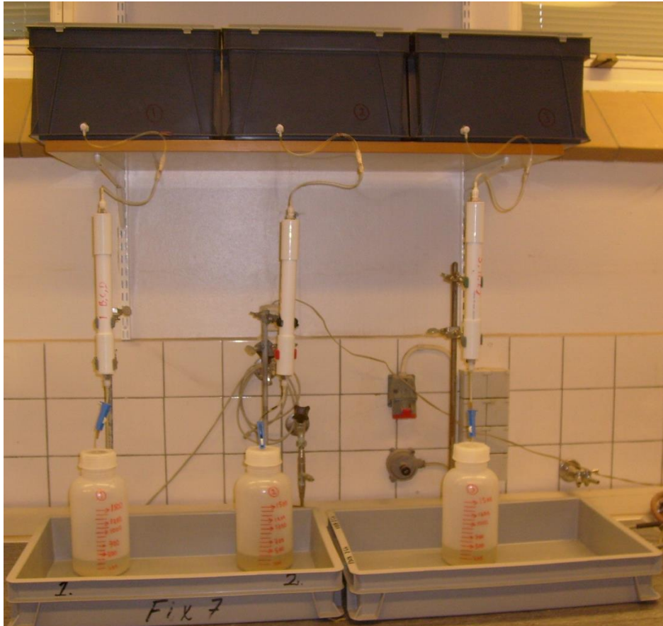
Figur 8-1, Försöksuppställning med vattnet i plastlådor högst upp, rören med cementbruk och uppsamlingsflaskorna för vattnet.
