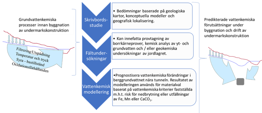
Figur 11-2. Schematisk beskrivning av föreslagen metodik för att prognosticera vattenkemiska förhållanden vid undermarks konstruktioner i syfte att ta fram underlag för materialval.
