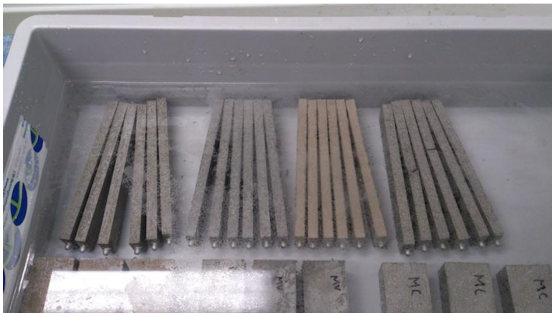
Figur 7-1, Indränkningstester (Immersionstester) av olika bruksprismor i sulfatlösningar.
